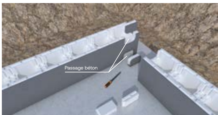
5 Passage béton haut et bas
