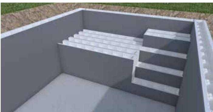
**5** Beispiel einer Treppe und einer Liegefläche, der Pool kann gegossen werden
